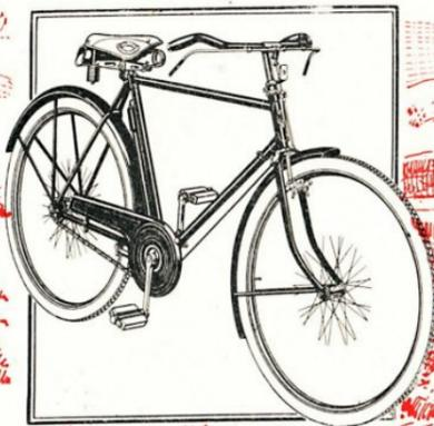
**MODÈLE «LUXE».** — Cadre en tubes de première qualité. — Roues de 28". — Pneus «Royale Saroléa» Prima de 38, 40, 45 ou «Ballon» au choix. — Pédales blocs-caoutchouc. — Chaîne «Coventry» de 1/2" x 1/8". — Garde-chaîne «Pistolet». — Guidon relevé recouvert de celluloid. — Selle «Saroléa» souple, à ressorts compensateurs ou rigide au choix. — Freins sur jantes AV et AR à commandes par tringles. — Fini : email de luxe. — Toutes pièces brillantes et jantes chromées.
